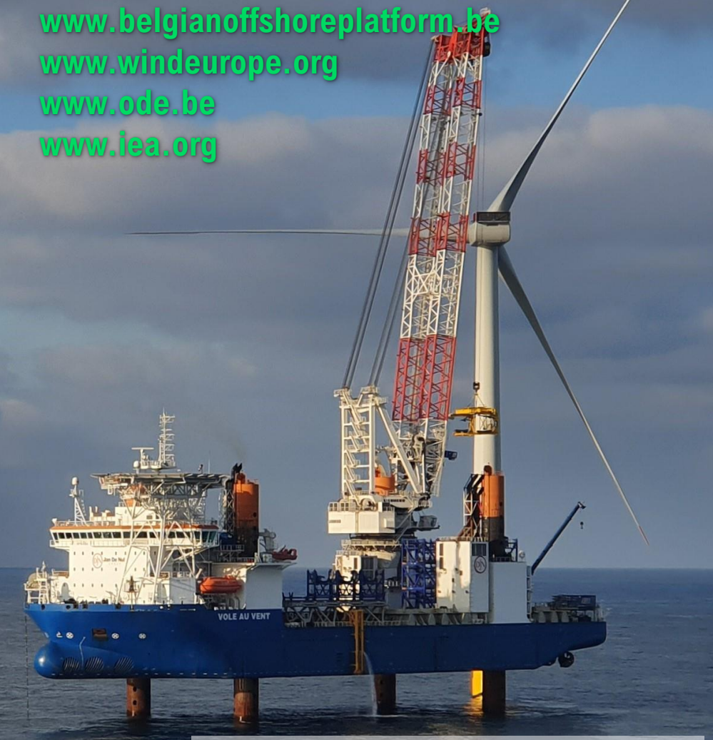
Le bateau "Vole au vent" de Jan De Nul a été utilisé pour l'installation de Nobelwind et de Northwester 2.
